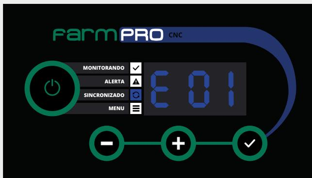
Seu monitor é uma potente ferramenta, ele já vem com um sistema de autodiagnóstico de sistema (único no mercado), quando detectar algum problema, automaticamente ele informará o código do erro junto com uma alarme sonora e visual (LED AZUL piscando)
