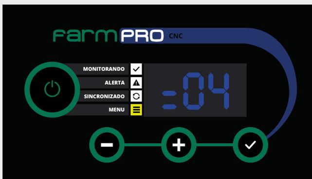
2- Na tela irá mostrar a quantidade de sensores que precisa estar contando semente para determinar se a máquina está plantando ou parada. Sempre colocar a metade +1 do total dos sensores. Exemplo: total de sensores 10, inserir 6.
